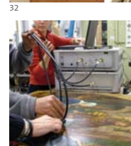
32. Riflettografo iperspettrale ad alta definizione per la spettroscopia ad immagini di dipinti.
