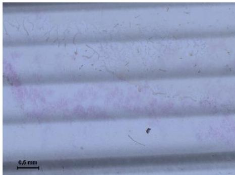
**Fig. 17** - Macchie di colore rosa e depositi di fango (stereomicroscopio, luce trasmessa, 25X)
