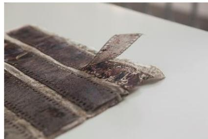
**Fig. 25 -** Adesione dell'emulsione alla *glassine* e deformazione del supporto
