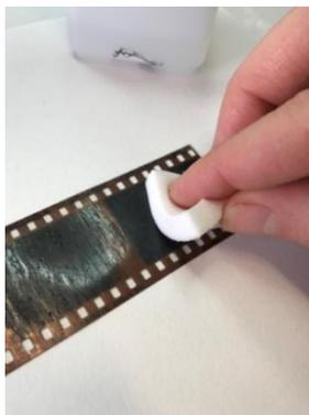
Fig. 17 - Pulitura del particolato con PU SPONGE® e acqua demineralizzata
