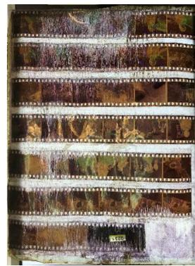
**Fig. 22 -** Adesione della *glassine* all'emulsione in luce trasmessa
