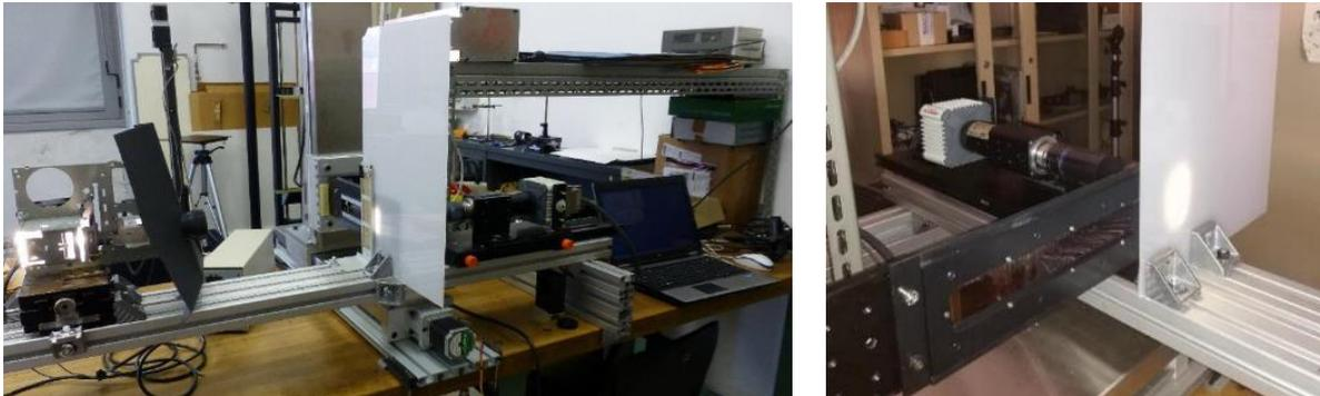
**Fig. 1** – Panoramica della strumentazione di spettroscopia d'immagine messa a punto per le misure su negativi e positivi 35 mm bianco e nero e colori.
