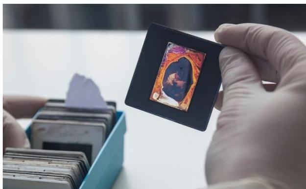
**Fig. 4 (Danni da alluvione – diapositive anni '90, dall'archivio D. Dainelli) –** Esempio di danni da alluvione subiti da pellicole a colori a sviluppo cromogeno. Si notano le tracce di fango sui telai ed il dilavamento perimetrale degli strati di colore. In particolare, di quello contenente il colorante ciano, (stratigraficamente, il più esterno), seguito dal magenta e dal giallo, fino alla perdita totale degli strati di gelatina. (ph Laura Messina)
