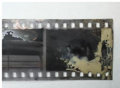
**Fig. 11** - Depositi di fango
