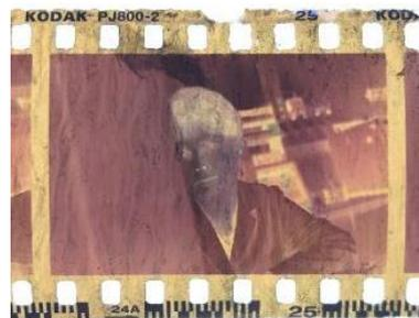
Fig. 2 - Negativo colore lato supporto pre prova di pulitura, foto in luce trasmessa.
