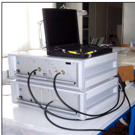
Fig. 2 - Spettranalizzatori Zeiss utilizzati per le misure FORS.
