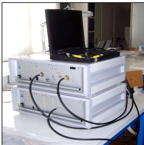
Fig. 2 - Spettroanalizzatori Zeiss MCS501 e MCS511 NIR 1.7 utilizzati per le misure FORS Fig. 3 - Particolare della sonda impiegata per l'analisi.
