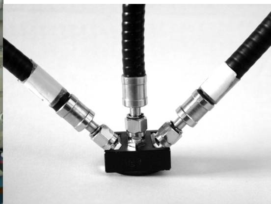
Fig. 2 - Spettroanalizzatori Zeiss utilizzati per le misure FORS. Fig. 3 - Particolare della sonda impiegata per l'analisi.
