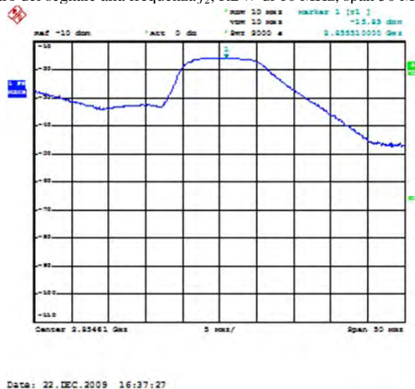
Fig. 9 - Spettro del segnale alla frequenza f_3 , RBW di 10 MHz, span 50 MHz, SWT 2000sec
