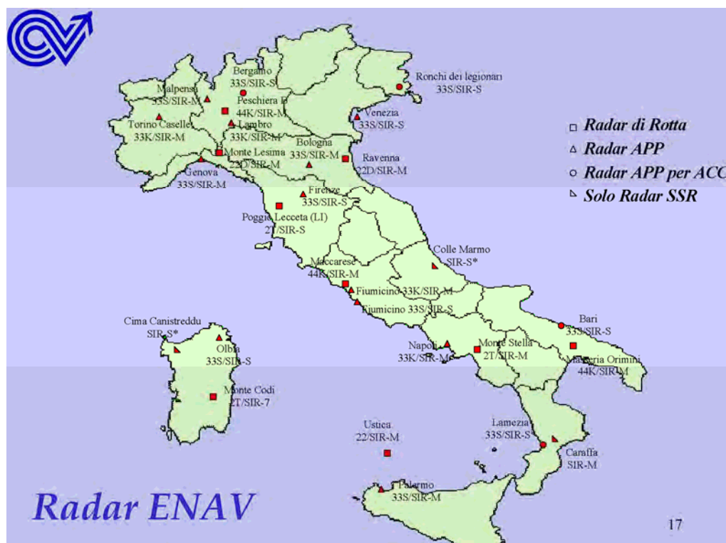
Fig. 2 - Mappa degli apparati radar della rete ENAV presenti sul territorio nazionale. Per ogni località viene indicato il tipo di radar primario 1 (cifra prima della barra) e, quando presente, il radar secondario 1 .
