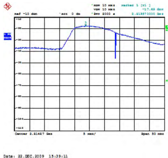
Fig. 8 - Spettro del segnale alla frequenza f_2 , RBW di 10 MHz, span 50 MHz, SWT 2000sec
