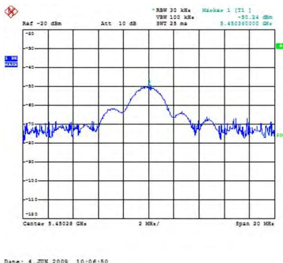
**Fig. 4** - Spettro del segnale radar filtrato con una RBW di 30 kHz, idonea per la misura della frequenza di lavoro del radar.
