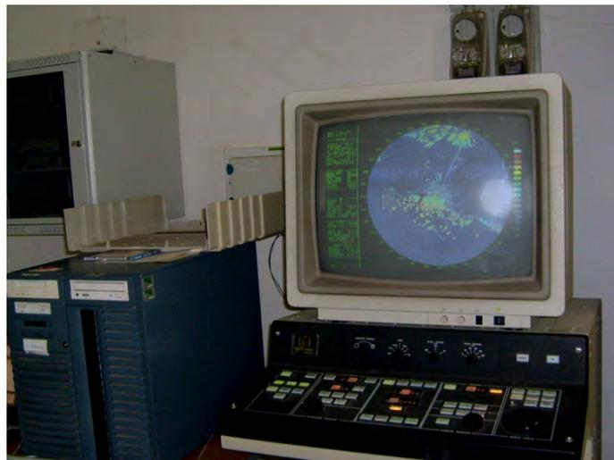
**Fig. 2** – Consolle per il controllo locale del radar.
