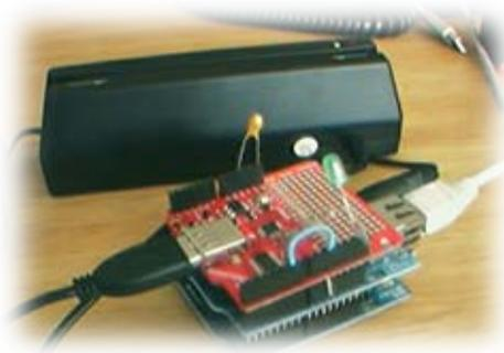
Per l'attivazione dell'elettroserratura è stato realizzato un semplice circuito di temporizzazione e comando (CTC) dotato di relè (NB: nella foto il CTC è stato simulato con un led di colore verde).
