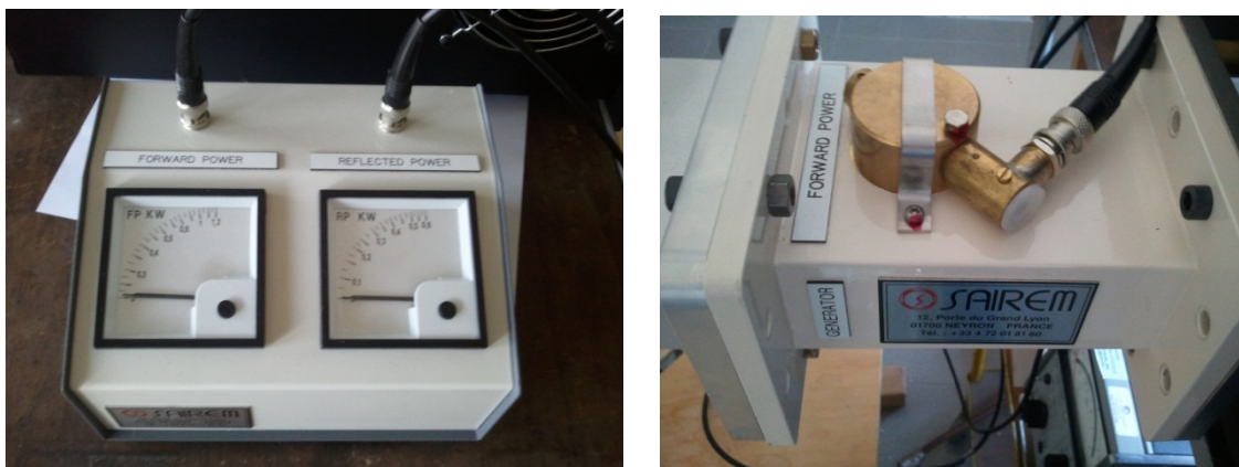
Fig. 14 - Immagini degli strumenti utilizzati: a sinistra il misuratore di potenza sotto analisi, a destra l’accoppiatore direzionale al quale è attaccato.
